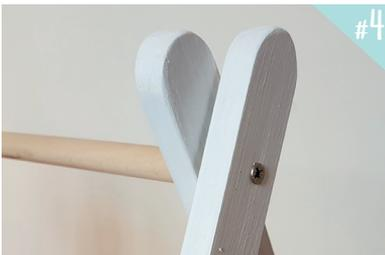
Assemblez les tasseaux et le tourillon. Afin de fixer le tourillon, placez une vis sur les tasseaux extérieurs creusés à moitié.
