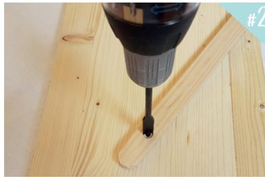
A 5 cm d'une des extrémités, percez 2 des tiges avec la mèche plate. Creusez les 2 autres avec la mèche sur la moitié de l'épaisseur du tasseau.
